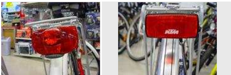
integrierter Rückstrahler oder eigenständiger Rückstrahler
